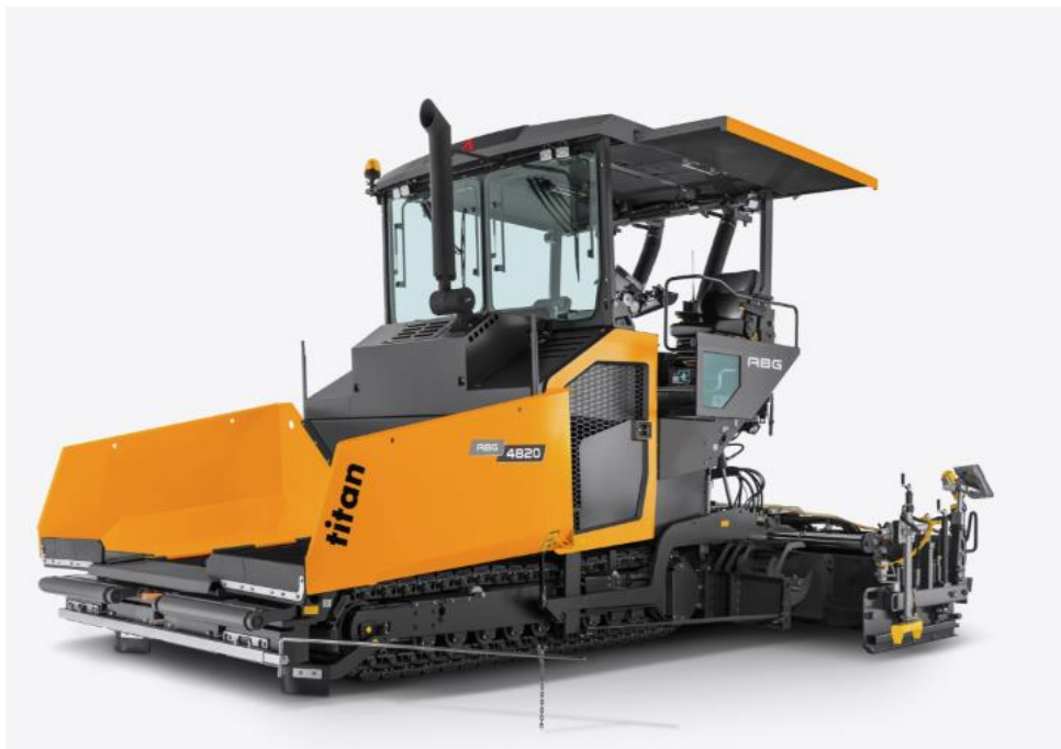
3. attēls. Asfaltbetona ieklājējs Ammann ABG 4820 vai analogs (EU stage V), jauda ir 175 kW, tiek darbināts, izmantojot dīzeļdegvielu
