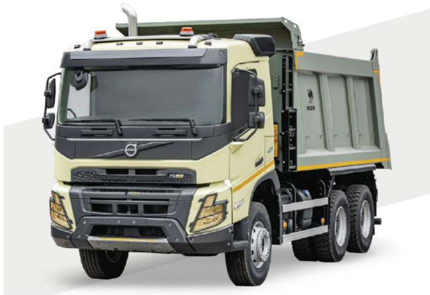
6. attēls. Kravas automašīna Volvo FMX vai analogs (Euro V), jauda ir 420 kW, tiek darbināts, izmantojot dīzeļdegvielu
