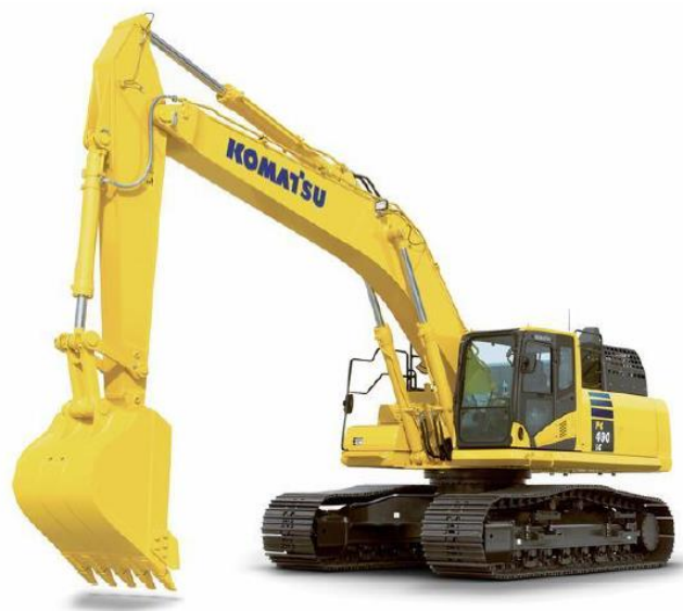
1. attēls. Ekskavators iekrāvējs KOMATSU PC490 vai analogs (EU stage V), jauda ir 270 kW, tiek darbināts, izmantojot dīzeļdegvielu
