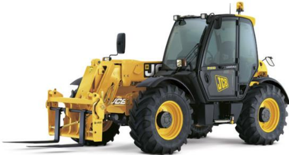
8. attēls. Teleskopiskais iekrāvējs JCB 531-70 vai analogs (EU stage V), jauda 81 kW, tiek darbināts, izmantojot dīzeļdegvielu
