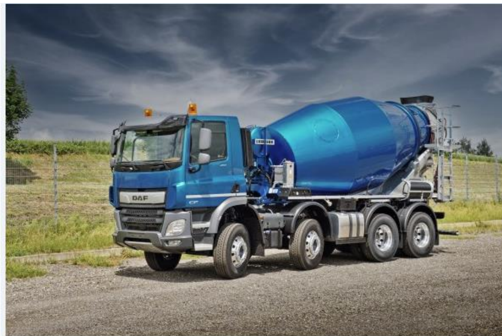
5. attēls. Betona maisītājs Liebherr 12 t HTM 805 vai analogs (EU stage V), jauda 294 kW tiek darbināts, izmantojot dīzeļdegvielu
